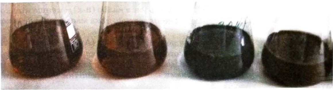
Рис. 1. Водні дисперсії препаратів наночастинок золота середніх розмірів 10 нм, 20 нм, 30 нм та 45 нм (зліва направо відповідно), синтезовані конденсаційним методом.
